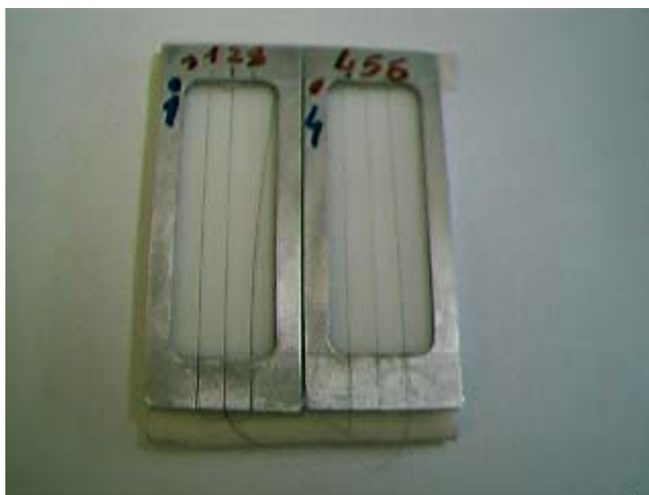
4. ábra: hajszálak rögzítése az alumínium kerethez hosszmenti vizsgálatokhoz
