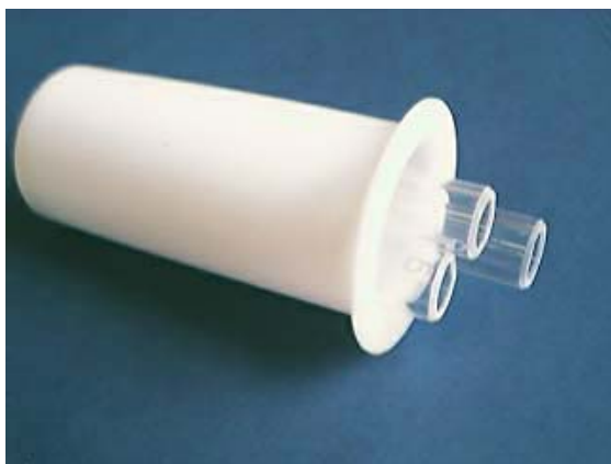
8. ábra: teflonbomba a behelyezett kvarckémcsővel
